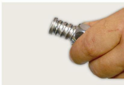
6. Одеваем накидные гайки
