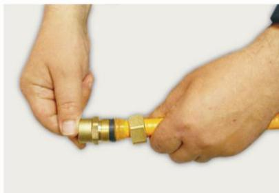
6. Обжимаем фитинг гаечным ключом
