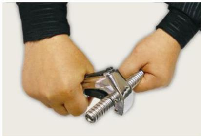
2. Помещаем отрезок трубы в вальцеватель
